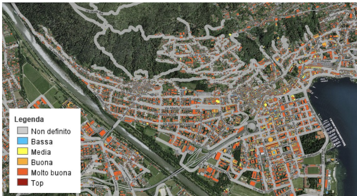
Fig.1: potenzialità solare delle superfici di tetti a Locarno (fonte www.tettosolare.ch ).
